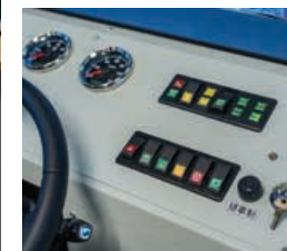
航空学院新增飞机牵引车模拟器，提供沉浸式及安全的飞机牵引和推后训练。模拟器以香港国际机场停机坪为训练场景，为学员带来接近真实环境的驾驶体验。操作台的版面及功能与实际运作时的牵引车一致，设有全互动式控制面板、力度反馈方向盘，以及脚踏控制器，确保训练时提供真实的触感反应。
