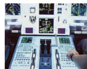
飞行模拟器 1:1 模拟驾驶舱内设有主仪表版、飞行控制组件 (FCU)，以及多用途控制及显示组件 (MCDU)
